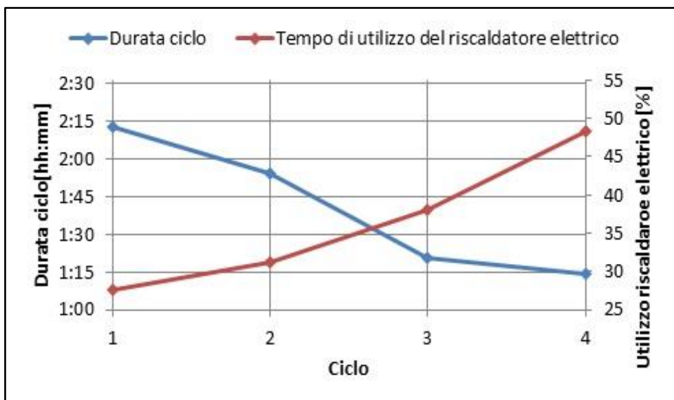
Figura 22. Confronto tra la durata di ogni ciclo e il tempo percentuale di utilizzo del riscaldatore per la rigenerazione per il filtro tipo B
