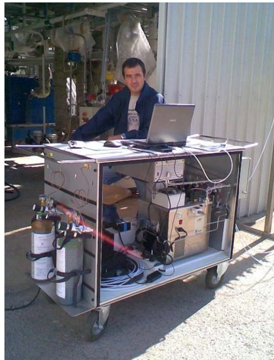
Figura 15 - Laboratorio mobile di analisi gas ENEA e carrello di prelievo e analisi gascromatografica
