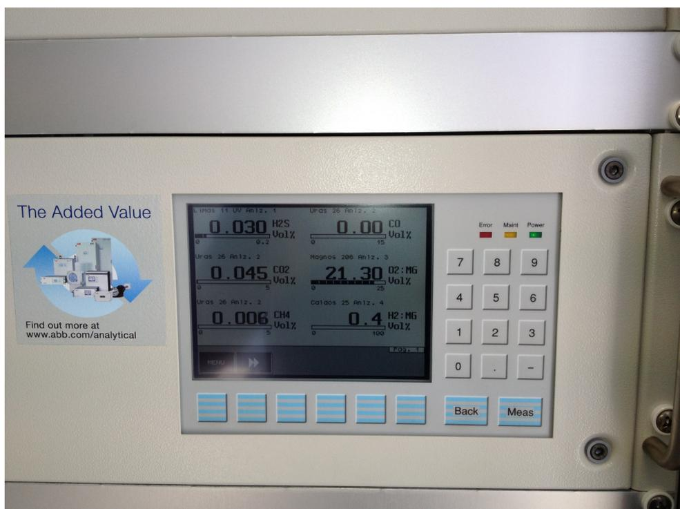
Figura 9 – Display unità centrale di controllo
