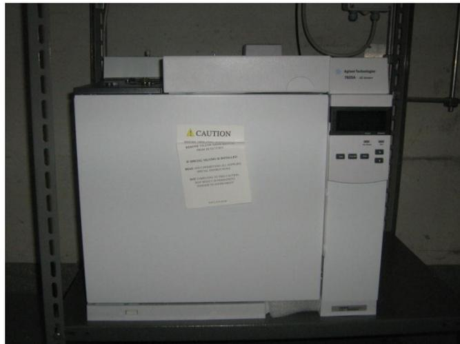
Figura 3.3: Gascromatografo per l'analisi dei prodotti.
