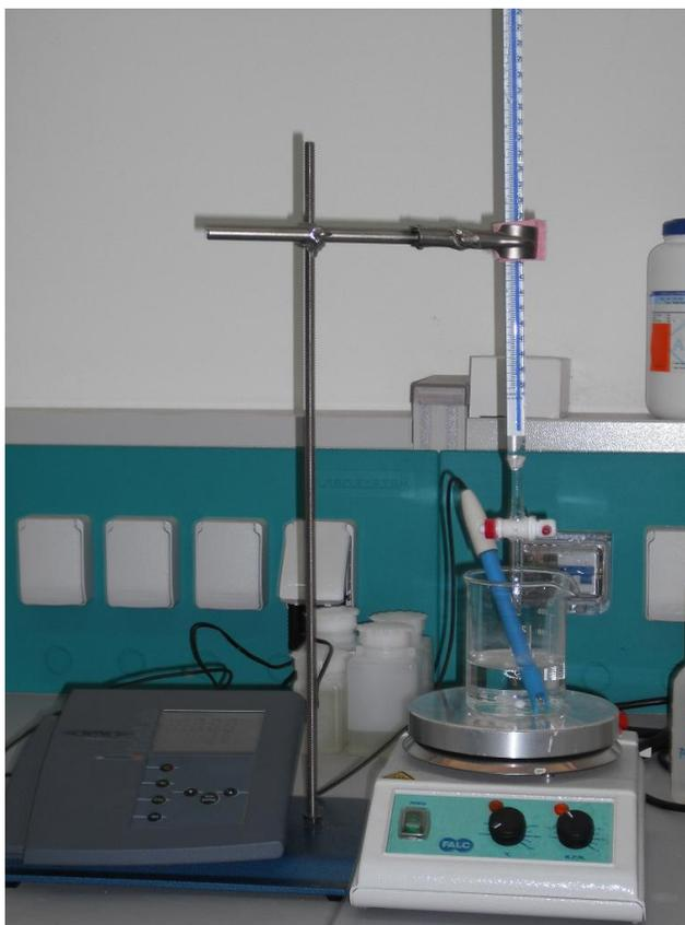
Figura 2.7. Fase di titolazione della metodica SINTEF.
