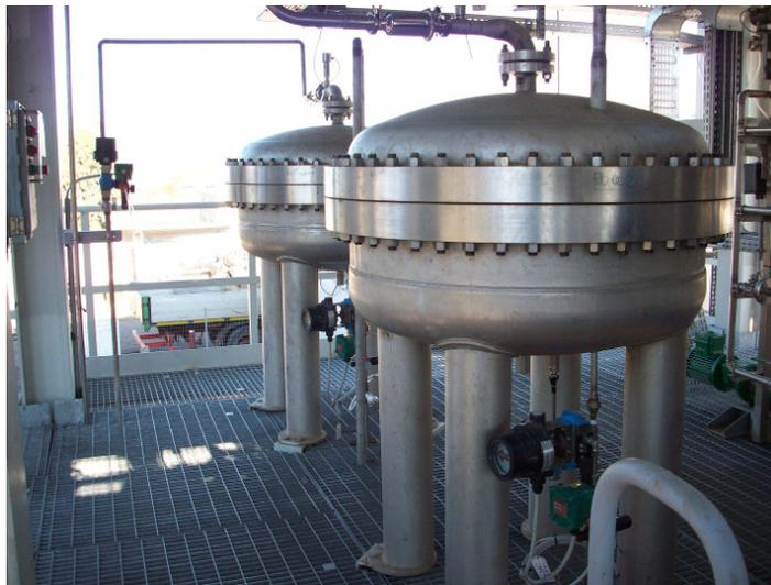
Figura 2.3. Reattori di assorbimento dell'anidride carbonica.
