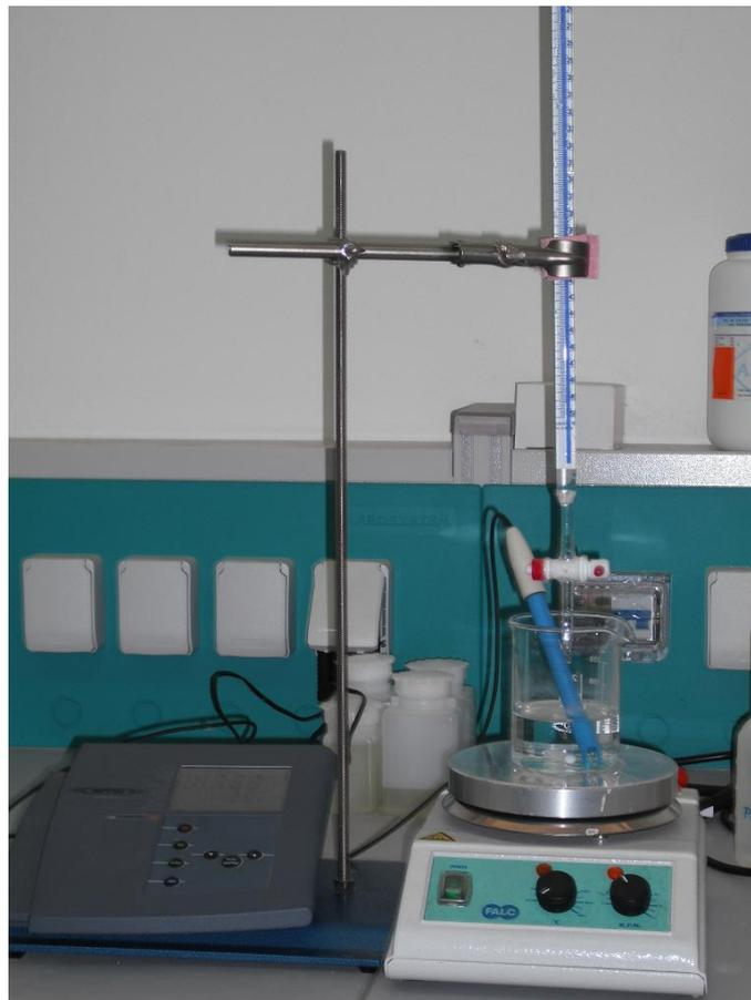
Figura 2.8. Fase di titolazione della metodica SINTEF
