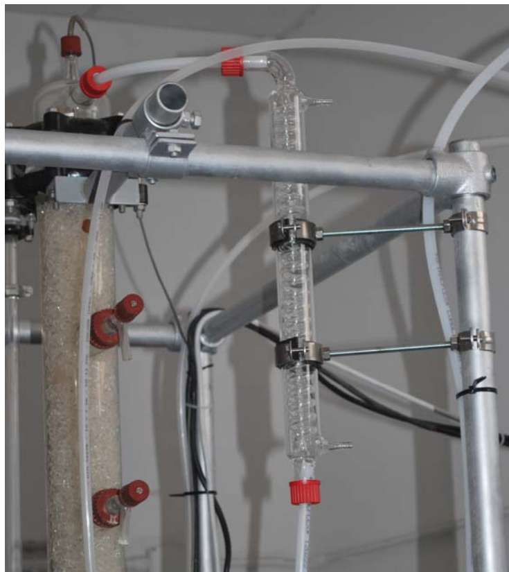
Figura 2.14. Sistema di condensazione.
