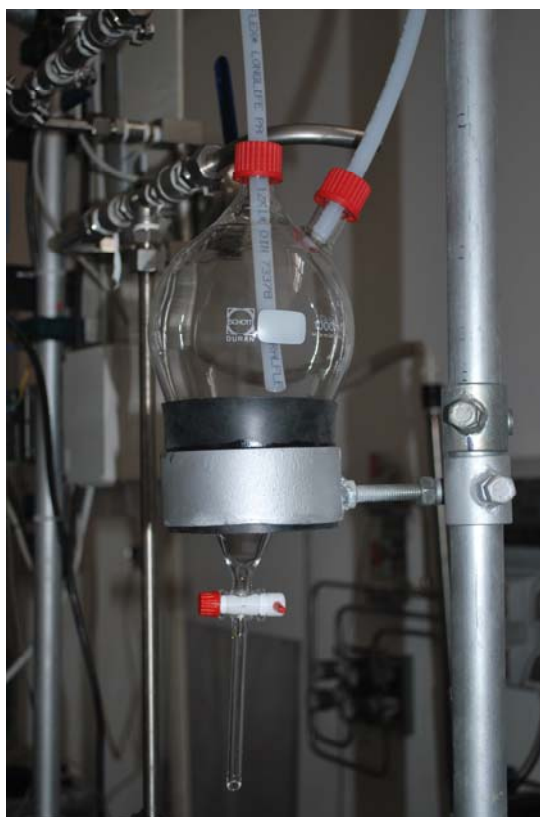
Figura 2.15. Sistema di separazione e scarico della condensa.
