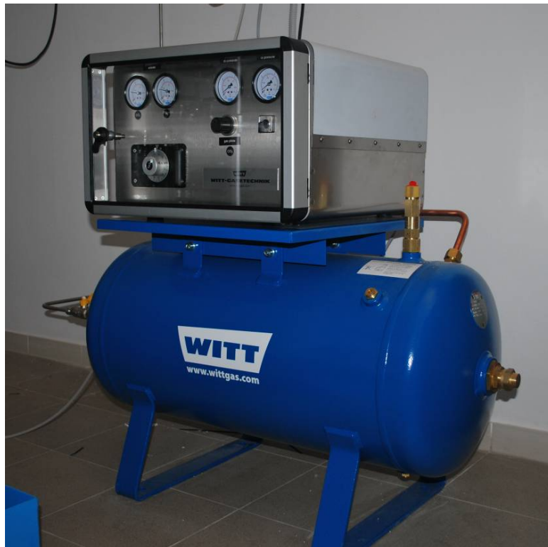
Figura 2.4. Sistema di miscelazione dei gas con polmone di accumulo.
