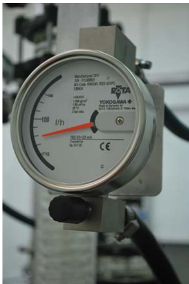
Figura 2.10. Particolare del sistema di misura e regolazione della portata di solvente.
