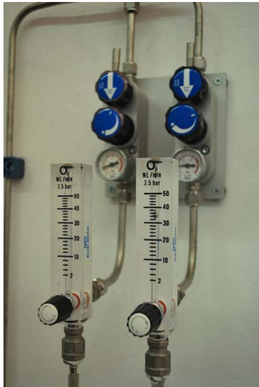
Figura 2.5. Sistema di regolazione finale della pressione e della portata della miscela gassosa.
