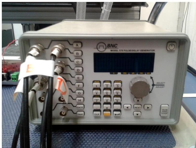
Figura 2.18: sincronizzatore "BNC model 575".
