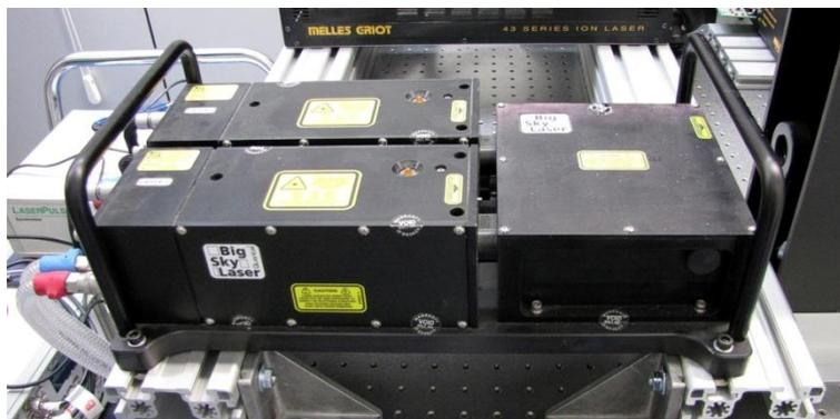
Figura 2.16: dispositivo laser “Quantel Big Sky Laser Twins BSL”.
