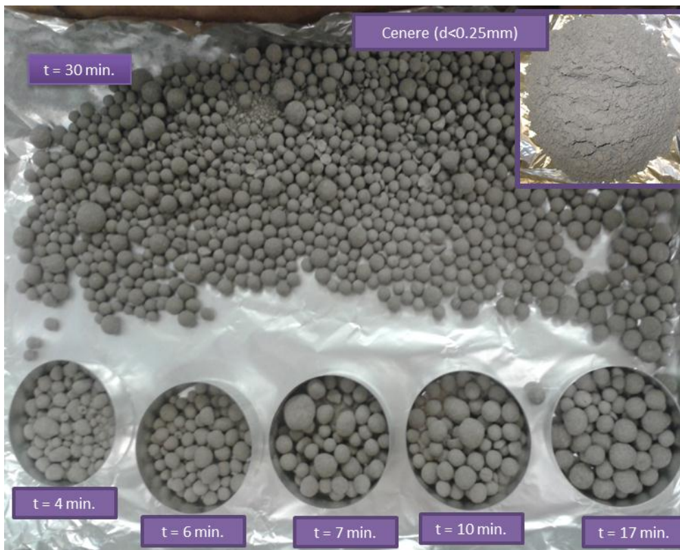
Figura 44. Granuli formati a diversi tempi di granulazione; confronto con la dimensione della cenere iniziale
