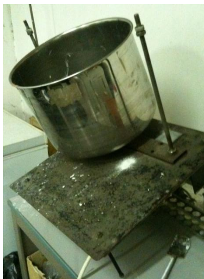
Figura 42. Corpo cilindrico centrale del reattore di granulazione.
