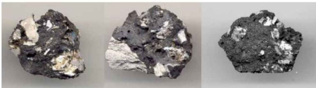
Figura 19. Clinker da gassificazione del carbone in un letto fisso (Matjie et al., 2006)
