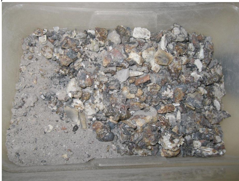
Figura 24. Campione iniziale di scorie da gassificazione del carbone nel reattore a letto fisso Wellman-Galusha
