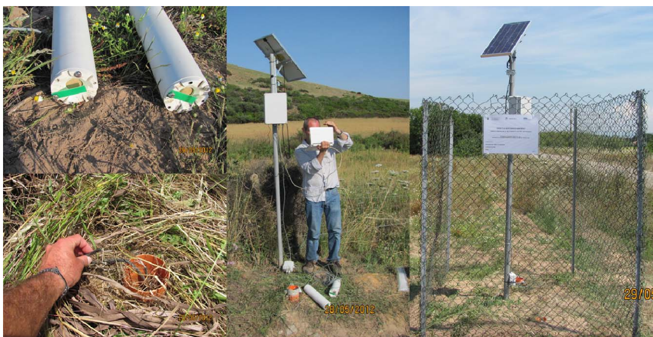
Figura 3. Intervento di manutenzione (maggio 2012) effetto per ripristinare la completa funzionalità dei sistemi e per verificare la corretta calibrazione delle sonde di misura.
