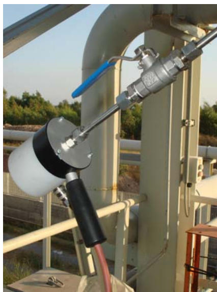
Fig. 42 – Sonda con filtro riscaldato per il campionamento del syngas
