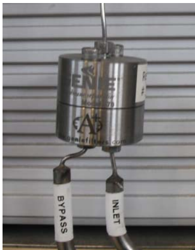
Fig. 2 - Membrana con filtro posta all'ingresso del micro-GC
