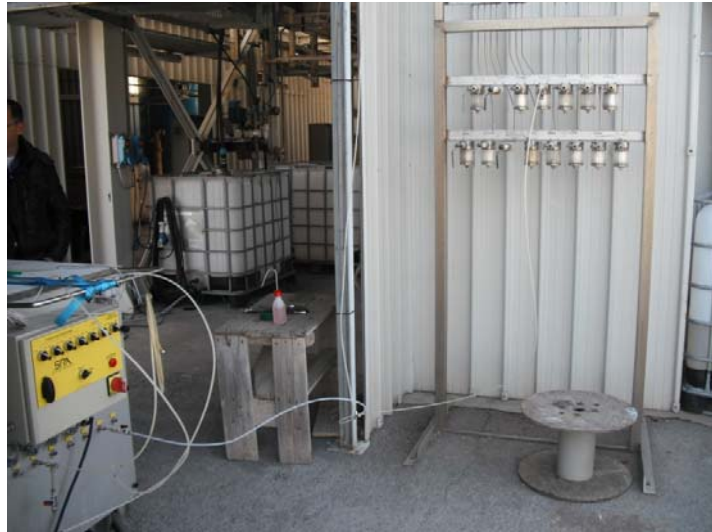
Fig. 13 - Collegamento tra rastrelliera e micro-GC per il campionamento e l'analisi del gas
