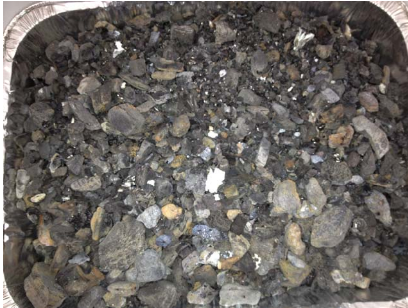
Fig. 39 – Scarico del reattore ricavato da una prova di gassificazione
