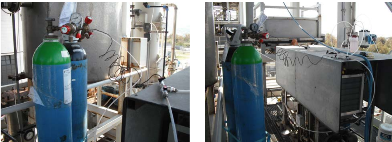
Fig. 19 – Sistema per l'abbattimento della pressione in uscita dalle bombole gas
