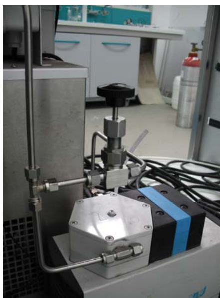
Fig. 18 - Inserimento valvola a spillo nel circuito \mu -GC
