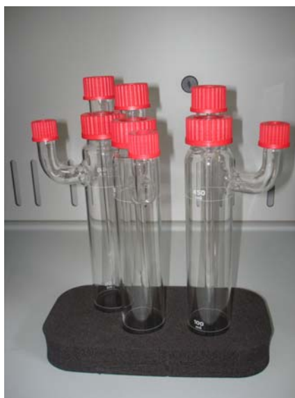
Fig. 43 - Sistema di gorgogliatori per la separazione dell'umidità e del TAR dal gas di sintesi
