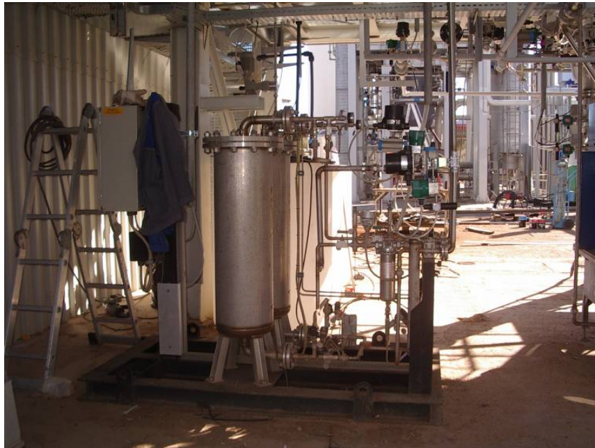
Figura 1.7. Il sistema PSA per la purificazione dell'idrogeno.
