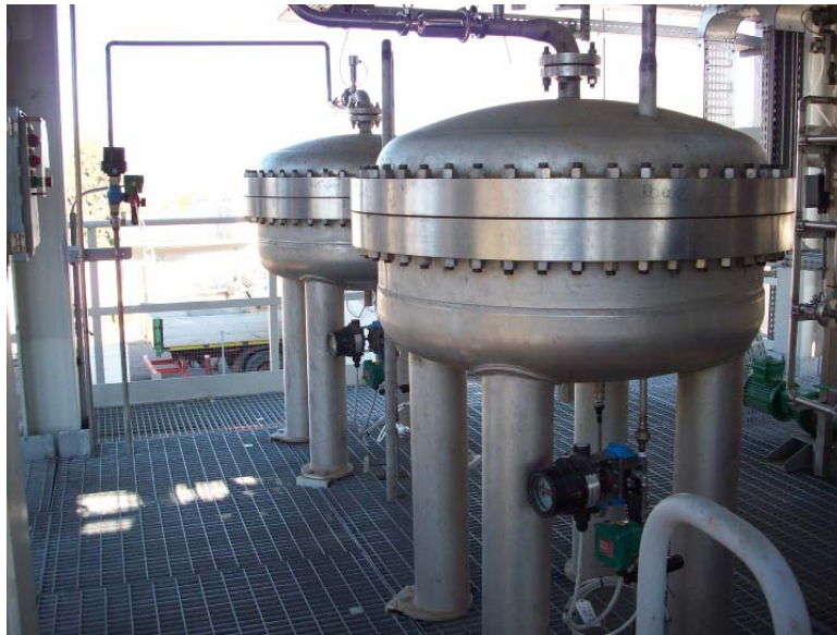
Figura 1.6. Reattori di assorbimento dell'anidride carbonica.
