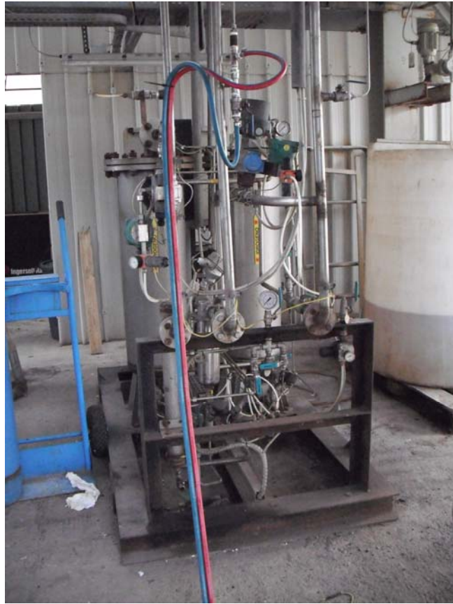
Figura 4.11 Prova funzionamento PSA con gas tecnici
