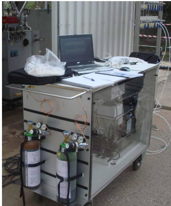
Figura 1.9. Gas cromatografo portatile per la misura della composizione del syngas.
