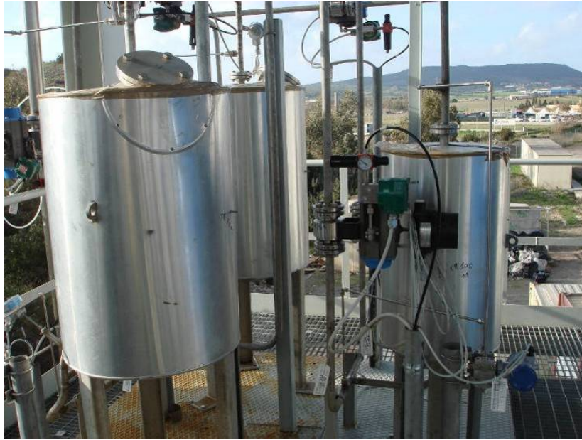
Figura 1.3. Sistema di desolforazione a caldo del syngas.
