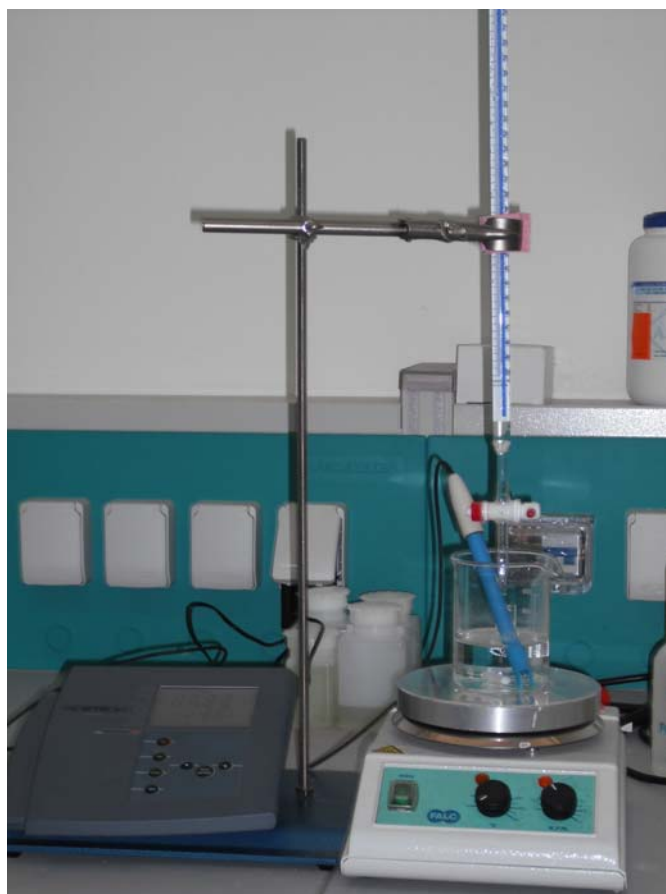
Figura 6.3. Fase di titolazione della metodica SINTEF
