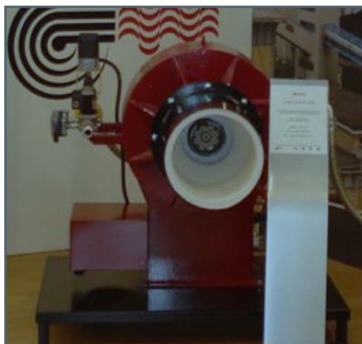
Figura 3.6. Particolare del bruciatore
