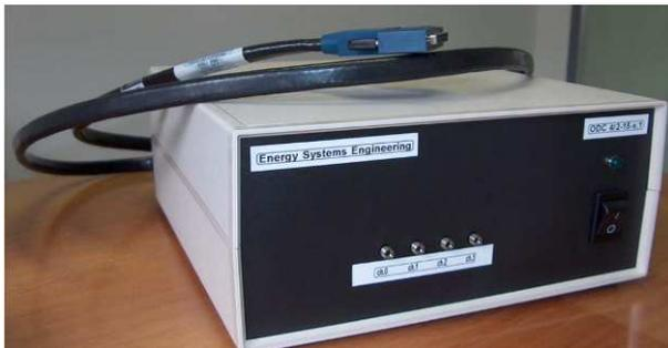
Figura 8 Box di interfaccia per la trasduzione ottica-elettrica
