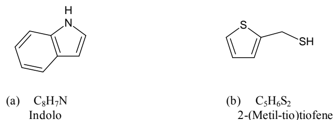
Figura 10: Possibili composti di riferimento per le specie TAR, azotate (a) e solforate (b)
