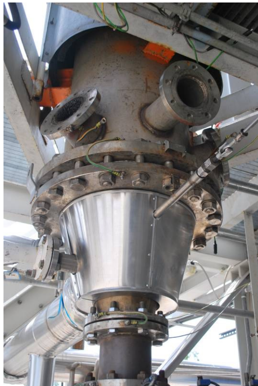
Figura 2.1. La parte inferiore del gassificatore pilota.
