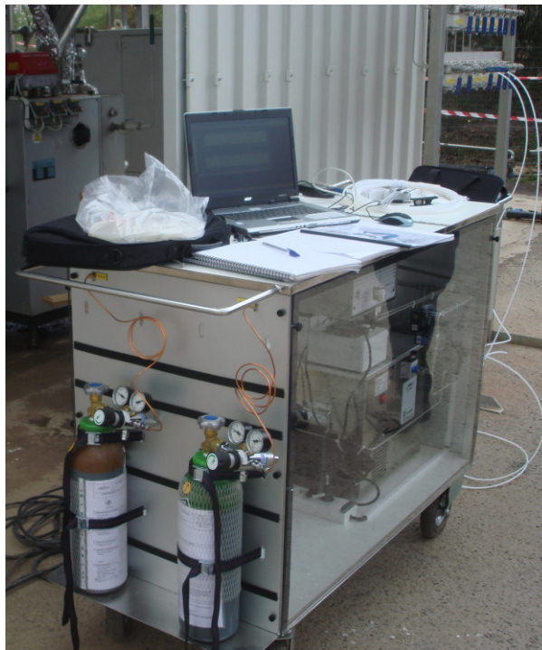
Figura 2.11. Gas cromatografo portatile per la misura della composizione del syngas.
