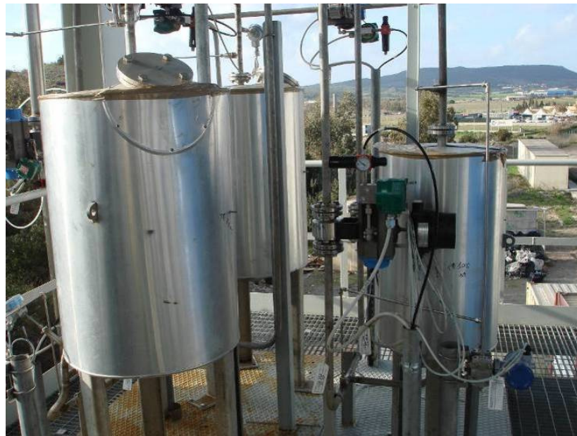
Figura 2.5. Sistema di desolforazione a caldo del syngas.
