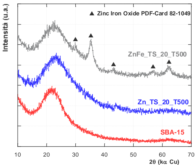
Figura 1. Diffrattogrammi XRD del supporto SBA-15 e dei sistemi nanocompositi a base di ZnFe_2O_4 e di ZnO con un carico del 20 wt% nell'intervallo angolare 2\theta = 10^\circ - 70^\circ ( \lambda_{CuK\alpha} )
