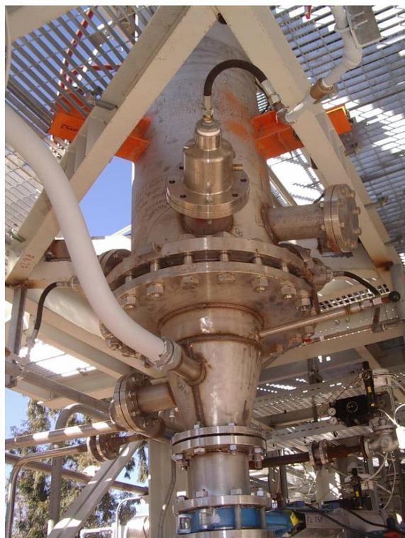
*Figura 6.1. La parte inferiore del gassificatore pilota Sotacarbo.*
