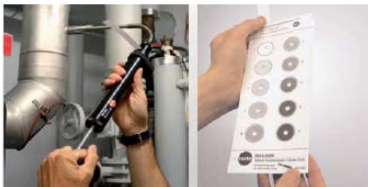
Fig. 6- Utilizzo dell'opacimetro manuale
