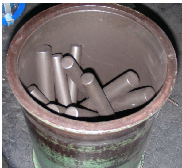
Figura 5.2.. : Particolare del mulino a barre.
