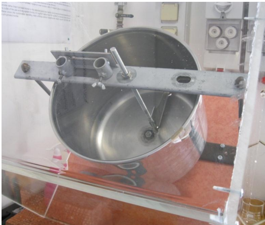
Figura 101. Fotografia del reattore di carbonatazione-granulazione realizzato.
