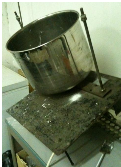
Figura 54. Corpo cilindrico centrale del reattore di granulazione.
