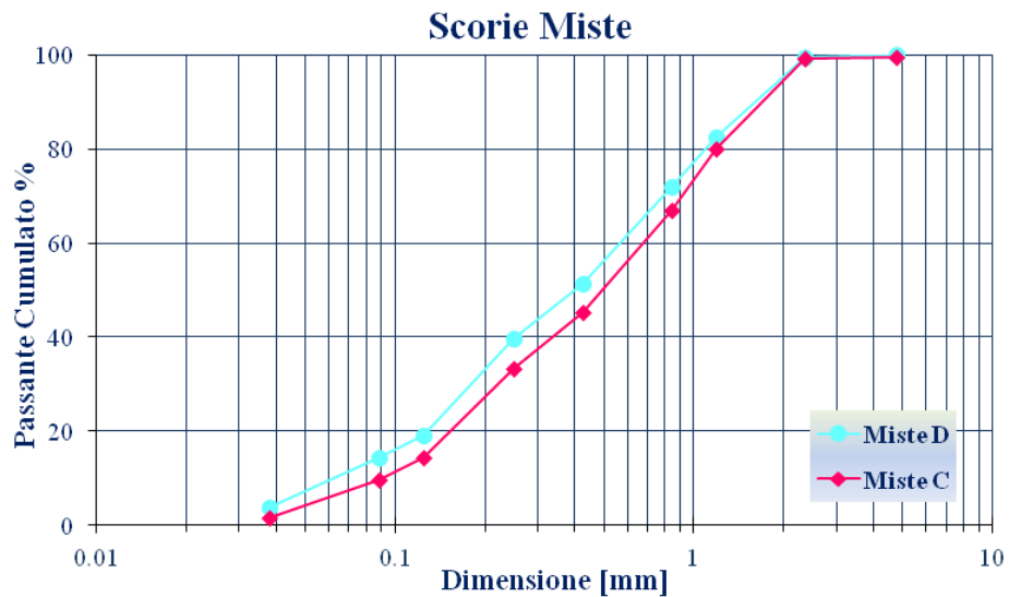
Figura 2. Distribuzione granulometrica della miscela di scorie miste analizzate.
