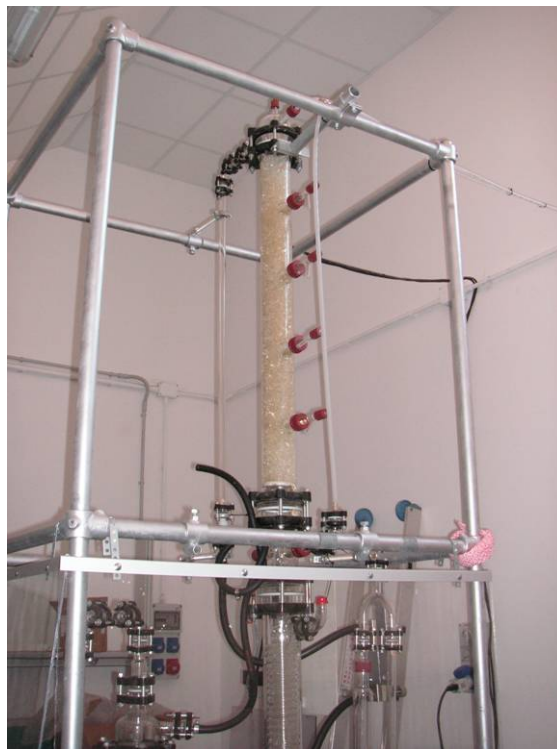
Fig. 18: Impianto da laboratorio di assorbimento di CO2
