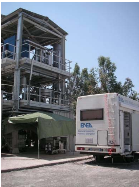
Fig. 14: Laboratorio mobile di analisi gas ENEA e carrello di prelievo e analisi gascromatografica
