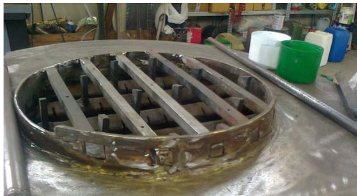
Fig. 18: Vista di dettaglio griglia fissa con aste flottanti in dilatazione.
