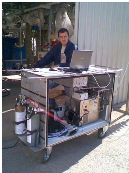
Fig. 14: Laboratorio mobile di analisi gas ENEA e carrello di prelievo e analisi gascromatografica
