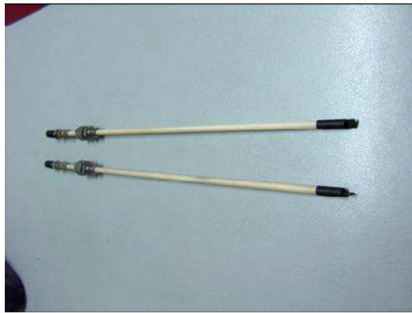
Figura 3: Sonda ODC per alta temperatura in zaffiro
