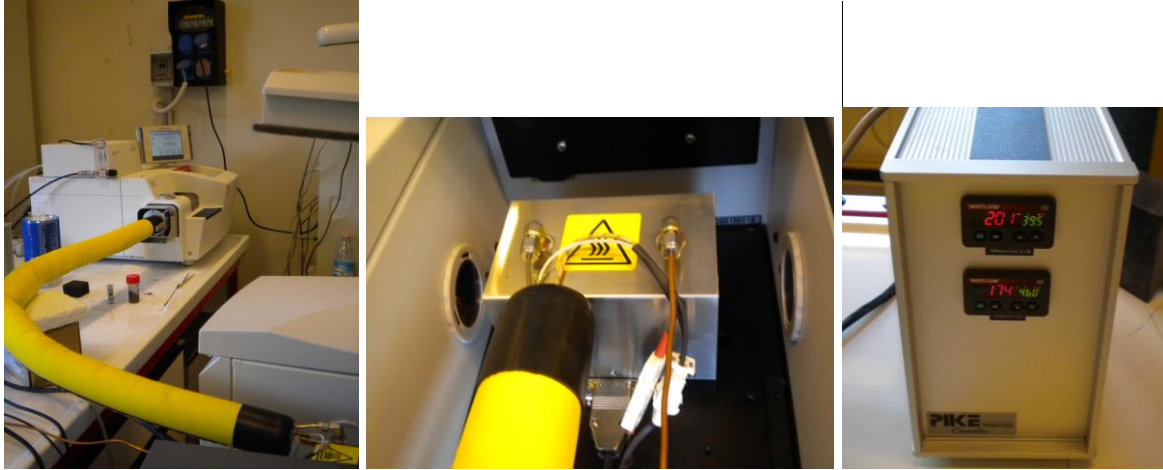
Figura 4: collegamento TGA-DSC e FT-IR, attacco della transfer line sulla cella riscaldata e controllore di Temperatura
