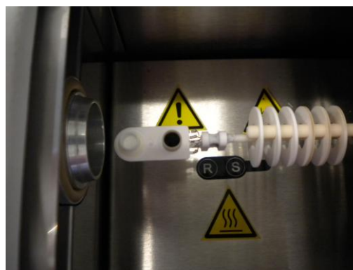
Figura 1: Bilancia Termogravimetrica e dettaglio del braccetto di misurazione con il crogiuolo del campione e del riferimento
