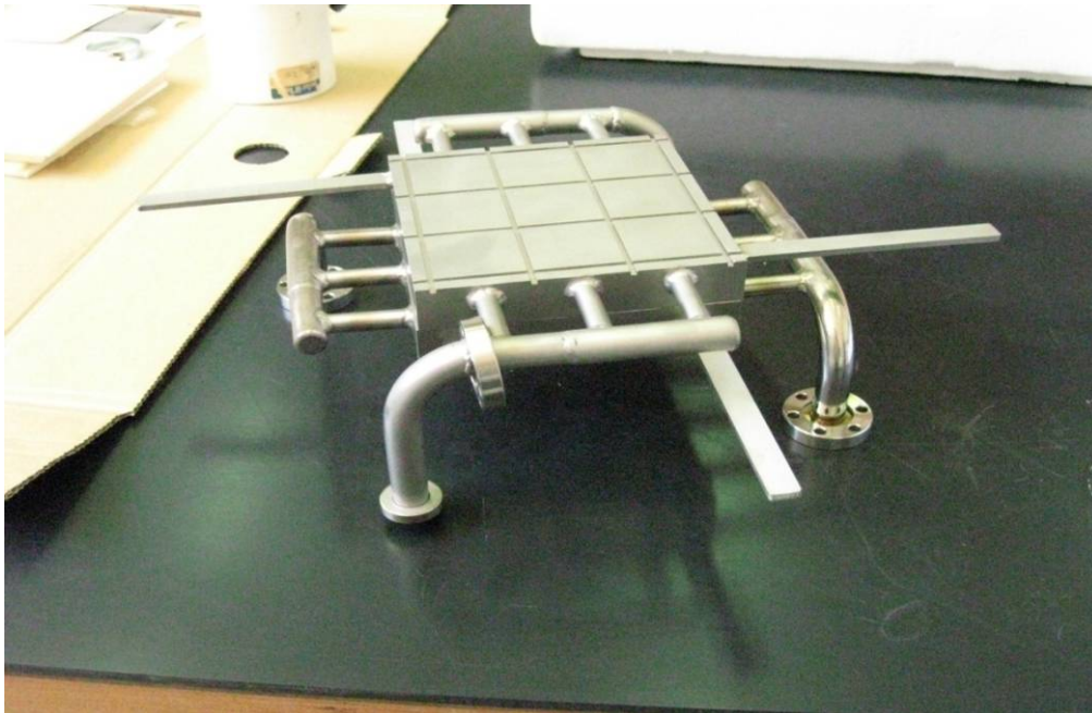
Figura 4. Monocella di tipo MCFC Ansaldo ARI.
