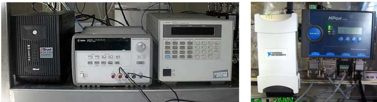
Figura 5. Gruppo UPS, generatore di tensione e carico elettronico (sx); scheda acquisizione termocoppie e convertitore RS-232/Ethernet (dx).
