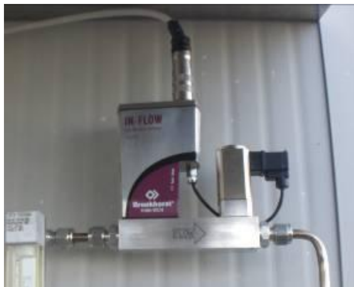
Figura 6 – Regolatore e rilevatore della portata dell'idrogeno
