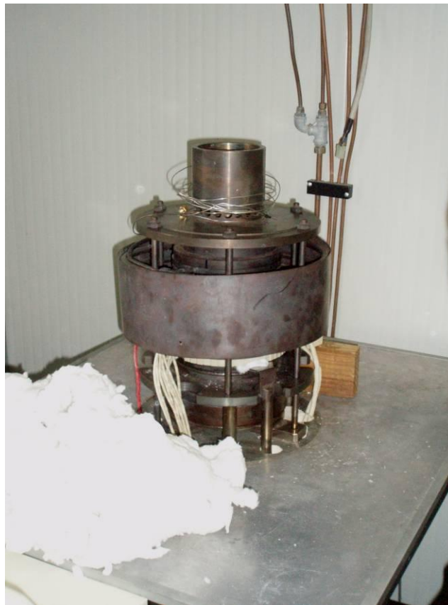
Figura 1 - Sistema MCFC di FN durante la fase finale dell'assemblaggio.
