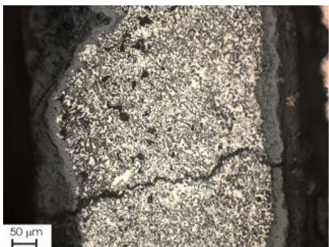
[Figura 35 200x MO Anodo C3 sezione: grossa cricca trasversale]
