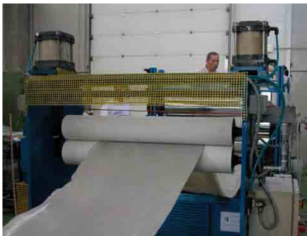
Fig. 26 – Uscita del materiale dal traino
