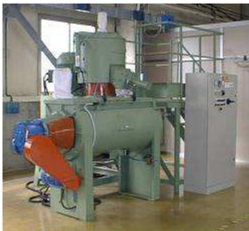
Fig. 13 – Turbomiscelatore Caccia di taglia semi-industriale
