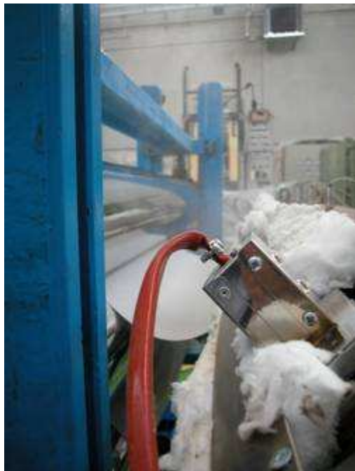
Fig. 23 – Estrusione compound essiccato bene
