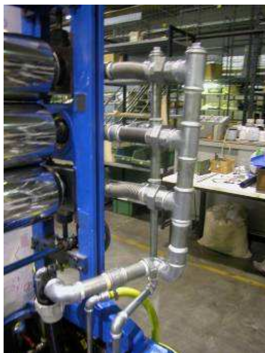
Fig. 17 – Particolari dell'impianto idraulico di raffreddamento della calandra
