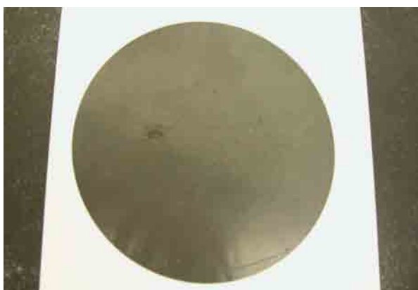
Fig. 69 – Campione di nichel ottenuto dopo pressatura a caldo di scatolini stampati con pressa ad iniezione
