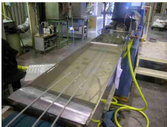
Fig. 68 – Estrusione di spaghetti a base Nichel
