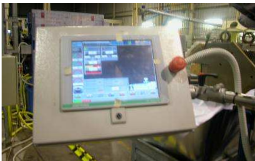
Fig. 16 – Particolare della consolle a touch screen per la gestione del software di processo
