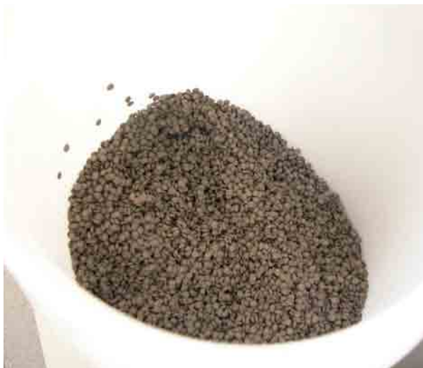
Fig. 73- Granulo rivestito di Nichel per catodo
