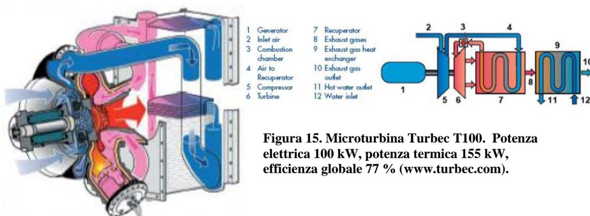
**Figura 15. Microturbina Turbec T100. Potenza elettrica 100 kW, potenza termica 155 kW, efficienza globale 77 % (www.turbec.com).**
