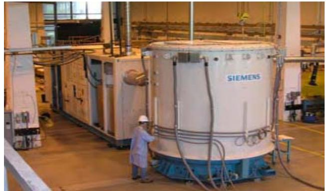
**Figura 17. Vista dell'impianto Siemens SFC-200: è possibile osservare il modulo elettrochimico (cilindro alto circa 3 metri) e il box contenente gli ausiliari.**
