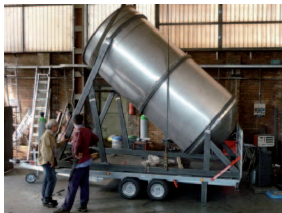
Impianto pilota di digestione anaerobica
