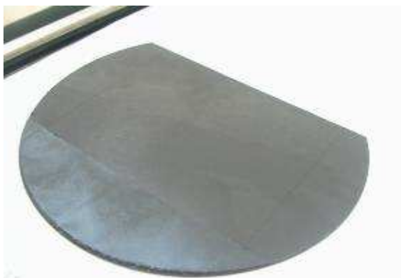
Fig. 3 – Taglio dei tondi a formare i campioni quadrati da sottoporre a trattamenti termici
