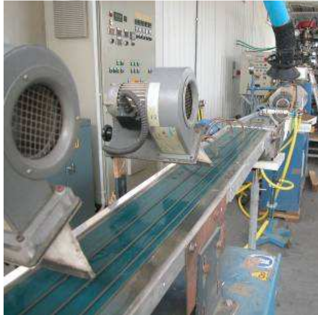
Fig. 1 – Estrusione compound Ni6
