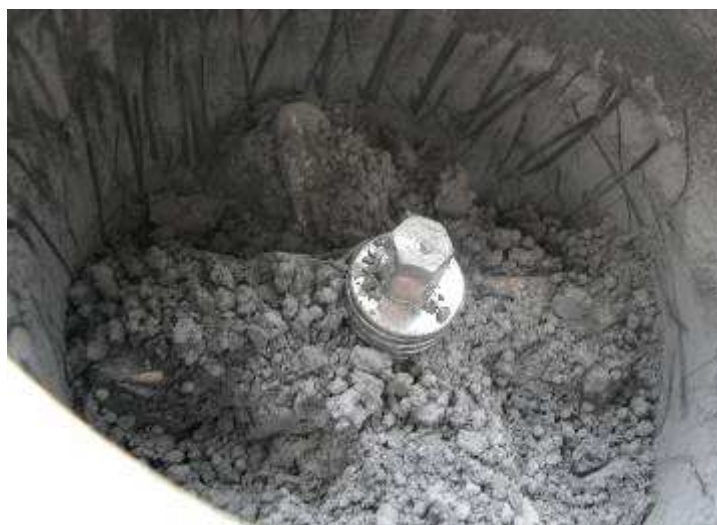
Fig. 2 – Immagine della mescola prima dello scarico dal turbomiscelatore
