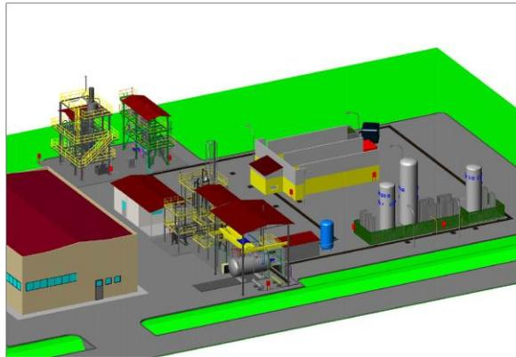
**Figura 17** *Rendering dell'impianto con celle a carbonati fusi*
