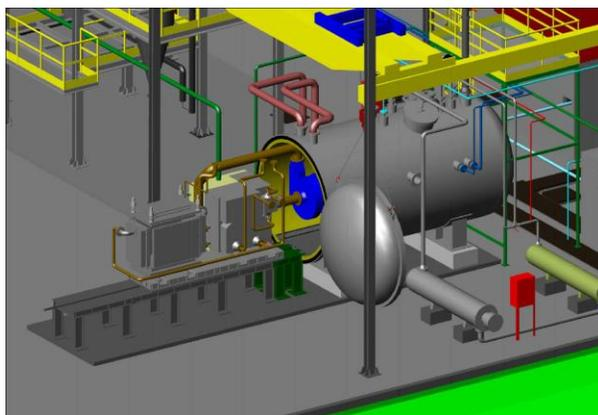
**Figura 18** Rendering cella a combustibile a vessel aperto
