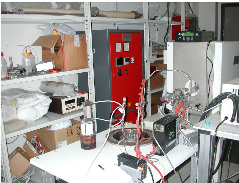
Fig. 3 Particolare dell'impianto CVD con il sistema di vaporizzazione (bubbler) e controllo di flusso del precursore (TEOS).
