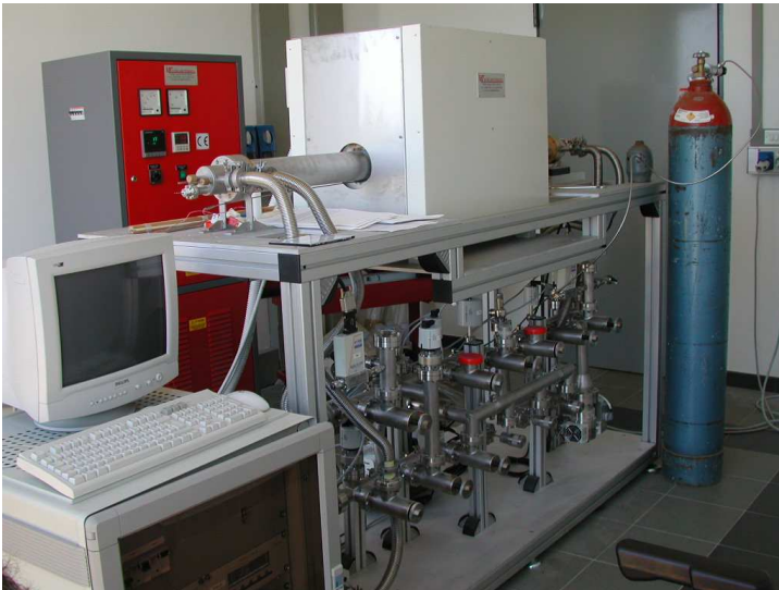
Fig. 1 Foto di insieme dell'impianto di misura della permeazione dei gas. In questo caso il campione aveva geometria cilindrica.
