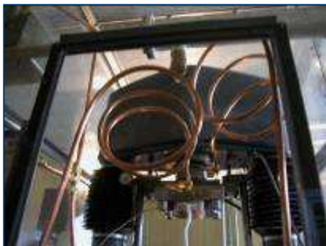
Fig. 2 – Modifiche al circuito di raffreddamento dello stampo per la pressa Komage K50 (a destra nuovo circuito)
