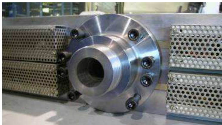
Fig. 10b - Parte del manicotto accoppiata ad entrata testa piana
