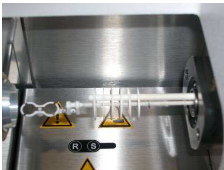
Fig. 17 – Particolare della camera della TGA/DSC 1 con sensore DTA
