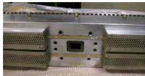
Fig. 9 - Testa piana di estrusione (a destra particolare della zona di ingresso del fuso nella testa)
