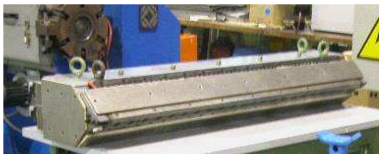
Fig. 9 - Testa piana di estrusione (a destra particolare della zona di ingresso del fuso nella testa)
