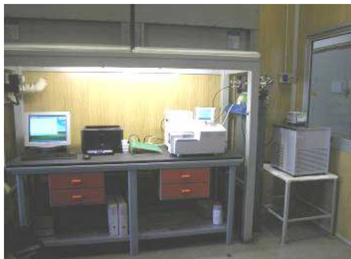
Fig. 15 - Apparecchiatura per analisi TGA-DSC Mettler Toledo installata presso FN
