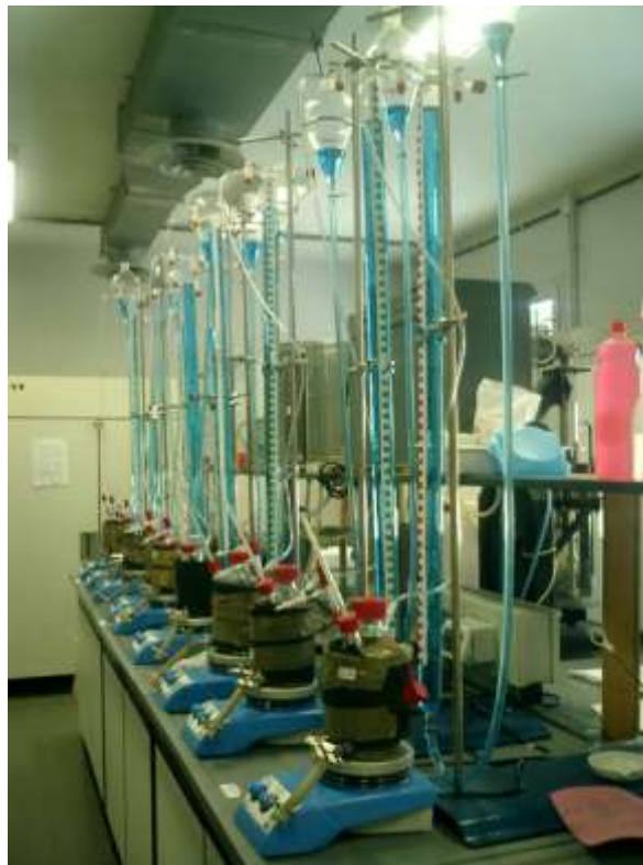
Fig. 3: Batteria di digestori ed eudiometri.
