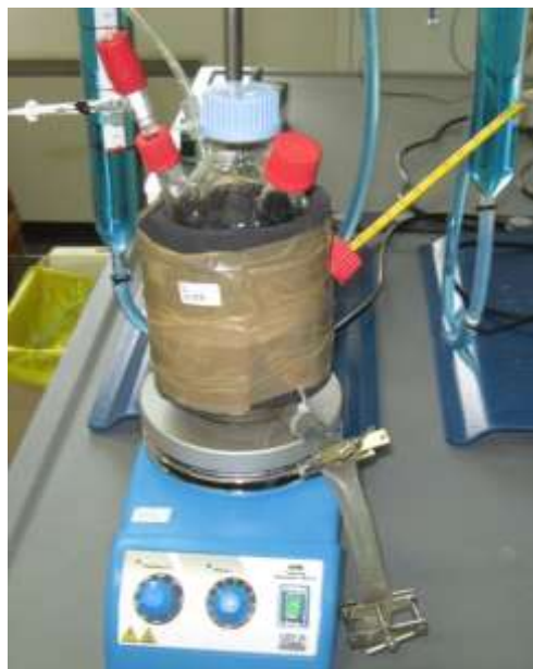
Fig. 2: Reattore batch coibentato, con sistema per il campionamento del digestato in basso e del biogas in alto.
