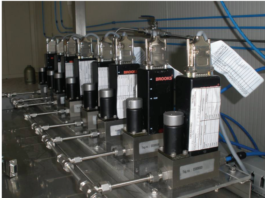
Figura 29 – Posizionamento dei flow-meters nel banco prova
