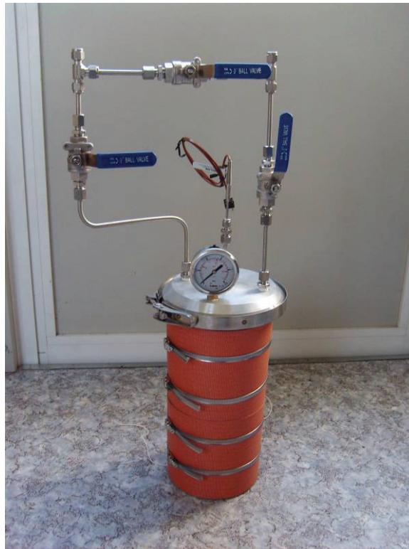
Figura 31 – Gorgogliatore: circuito di by-pass e di drain
