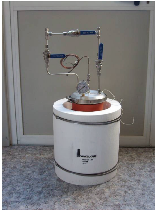
Fig. 33 – Gorgogliatore: sistema di isolamento termico
