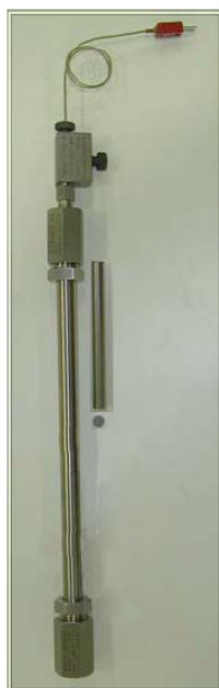
Figura 9 - Microreattore con cestello per il catalizzatore, porous plate e termocoppia.
