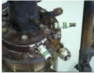
Figura 15. Candele per l'accensione della miscela metano aria
