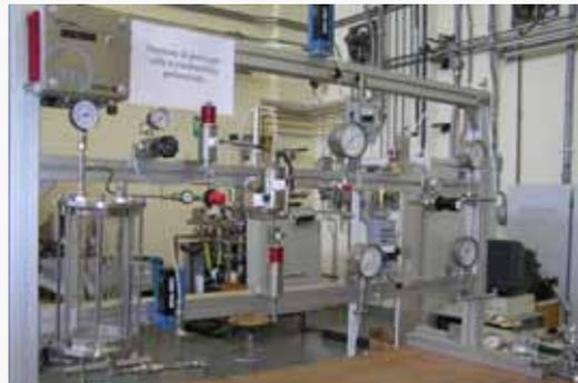
Stazione di prova per celle da 500 cm<sup>2</sup>
