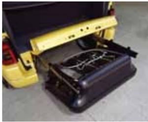
Nel gennaio 2002 è stata presentata una concept car, la H2O, un veicolo per i vigili del fuoco, che si differenziava dai prototipi che l'hanno preceduta in quanto alimentata con idrogeno ottenuto a bordo da sodio boridruro.
