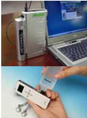
Sistemi a celle a combustibile per elettronica di consumo (< 50 W) -
