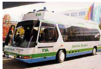
A Monaco, era stato quindi presentato (2000) il Bayernbus II, veicolo tecnologicamente più avanzato su cui era installata una cella da 80 kW (18 stack) della **Proton Motor Fuel Cell GmbH**.
