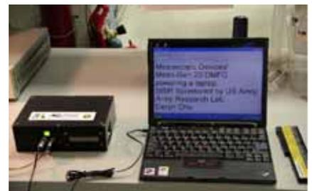
La serie di prodotti MesoPower che utilizza la tecnologia a metanolo diretto e copre un intervallo di potenza da 20 a 100 W, come abbiamo visto, era stata sviluppata per usi
