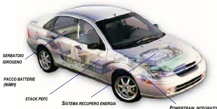
A fine 2006, è stato presentato un nuovo veicolo, l'Explorer, realizzato nell'ambito di attività finanziate dal DoE. Il veicolo utilizza un serbatoio capace di contenere 10 kg di idrogeno (700 bar), che gli consente un'elevata autonomia (560 km). Il serbatoio occupa lo spazio utilizzato nel modello in produzione dal sistema di trasmissione automatico a 6 marce, il veicolo mantiene quindi abitabilità e capacità di carico del modello tradizionale.
