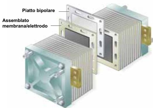
**Stack di celle ad elettrolita polimerico**
