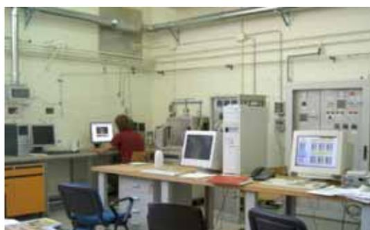
Stazione di prova celle MCFC da 100 cm<sup>2</sup>
