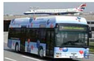
A maggio 2004 era stato presentato un prototipo di 2ª generazione sviluppato nel quadro del Progetto "Idrogeno per l'Aeroporto di Monaco" (Progetto ARGEMUC). Sul veicolo, realizzato in configurazione ibrida, è installata un'unità PEFC da 68 kW fornita da Ballard. La cella ed il pacco batterie (idruri metallici) forniscono una potenza complessiva di 150 kW ai due motori di trazione.
