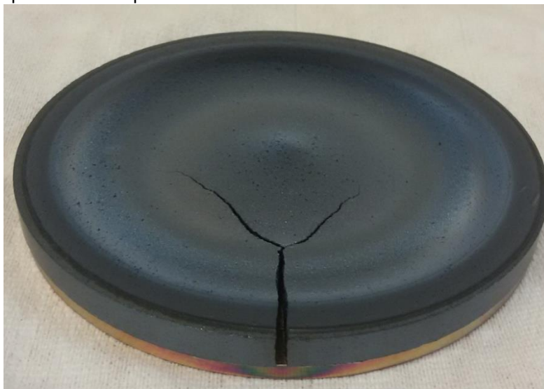
Figura 1: Fratture formate nel target di CuS durante il suo utilizzo
