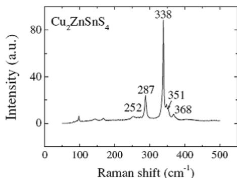
**Figura 3:** Spettro Raman a temperatura ambiente di polvere monocristallina di CZTS
