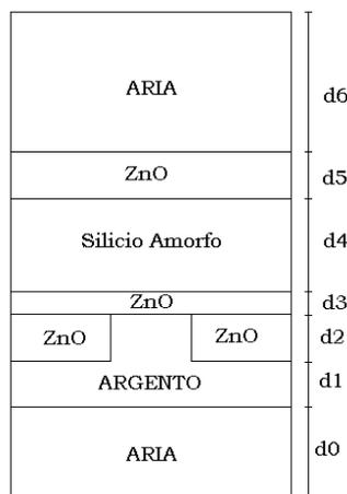
Figura 16 - Struttura della cella con lo strato di ZnO tra la nanogriglia e il layer attivo
