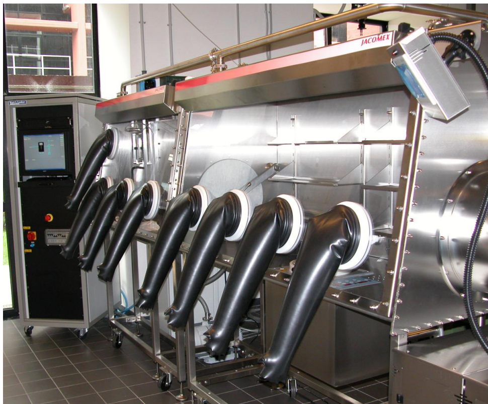
Glove box per la fabbricazione di celle polimeriche in atmosfera inerte installata nei laboratori dell'ENEA di Portici
