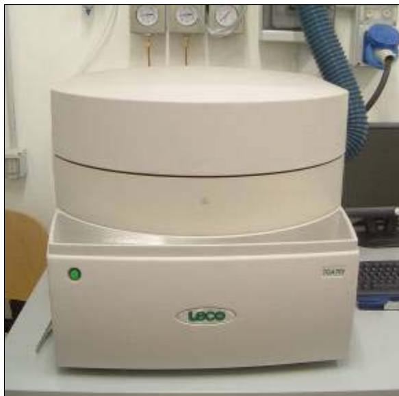
Fig 4: Analizzatore termogravimetrico per l'analisi dell'umidità.
