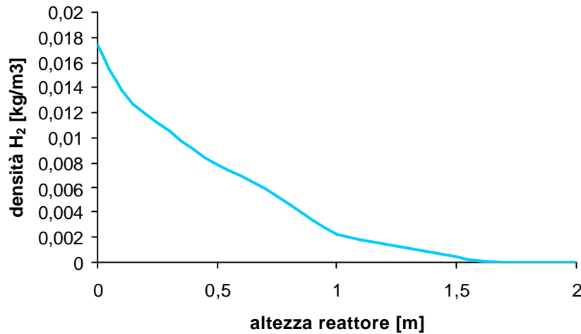
Fig. 32 – Profilo di concentrazione dell'H 2 lungo il reattore
