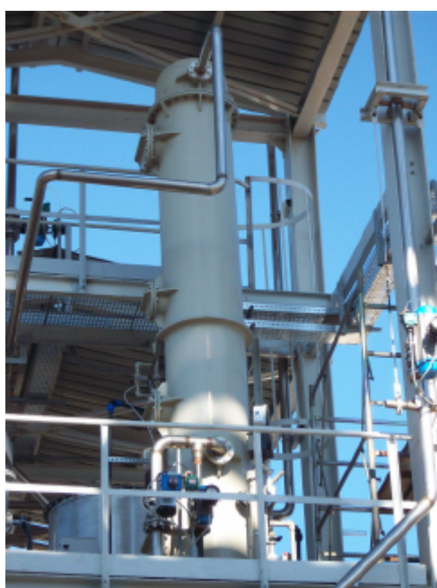
Figura 10: colonna di desolforazione a freddo
