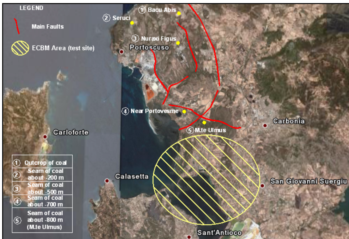
Fig. 1: Nella figura è riportata la possibile area d'indagine per l'applicazione delle tecniche CBM e ECBM. Il sito per i primi tests potrebbe essere localizzato nella parte a SW del bacino carbonifero, dove sono segnalati sondaggi che hanno rinvenuto livelli di carbone alla profondità di circa -800 m. ( requisito fondamentale per l'applicazione della tecnologia ECBM ).
